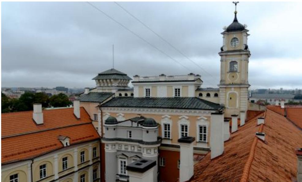
Fig. 67, 68 : La ligne blanche horizontale coupant la toiture du bâtiment occidental de la Cour de l'Observatoire signale l'existence d'un mur pare-feu à cet endroit. C'est aussi la trace du mur de façade antérieur à l'addition des portiques sur arcades. (Photo 586086 et 590054 MH 2013).
