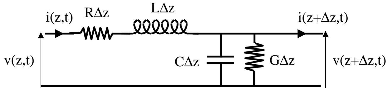
Pour un support de propagation donné, les paramètres  $L$ ,  $C$ ,  $R$  et  $G$  peuvent être déterminés par la théorie des champs ou à partir de mesures
