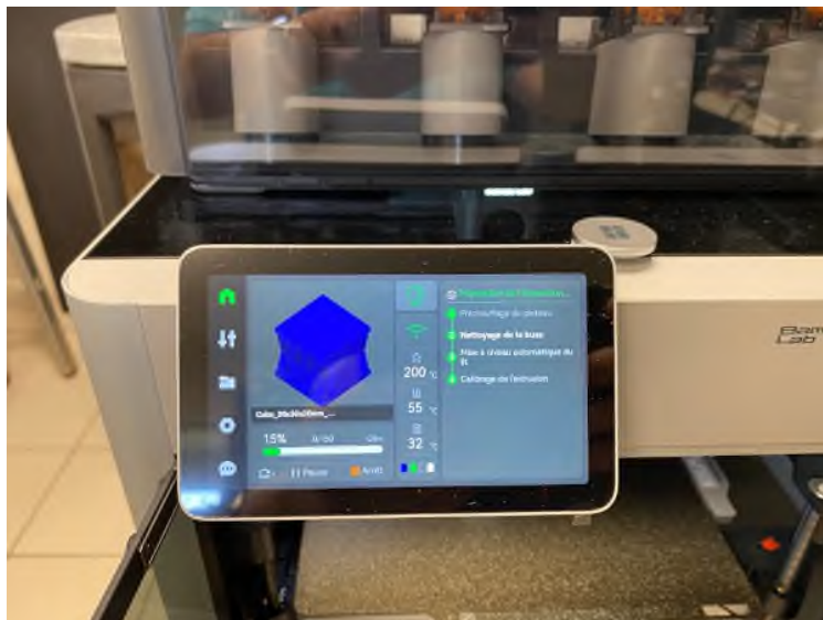
FIGURE 32 – Démarrage de l'impression : Nettoyage de la buse
