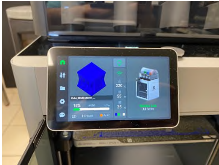
FIGURE 35 – Impression en cours : Première couche en cours
