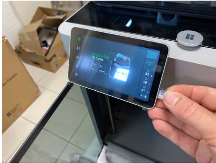
FIGURE 26 – Insertion de la carte SD dans le coin inférieur droit de l'écran.
