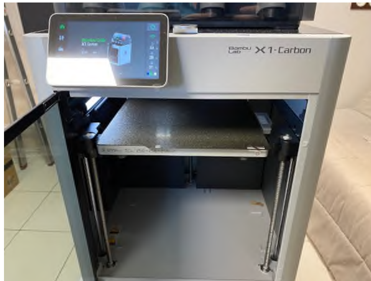
FIGURE 25 – L'imprimante doit être vide de toute impression et le plateau magnétique doit être en place.
