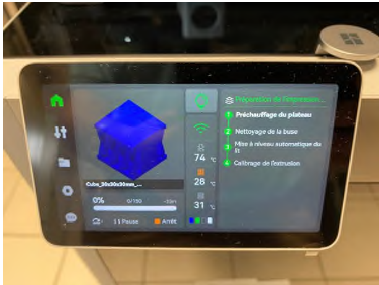
FIGURE 31 – Démarrage de l'impression : Préchauffage du plateau
