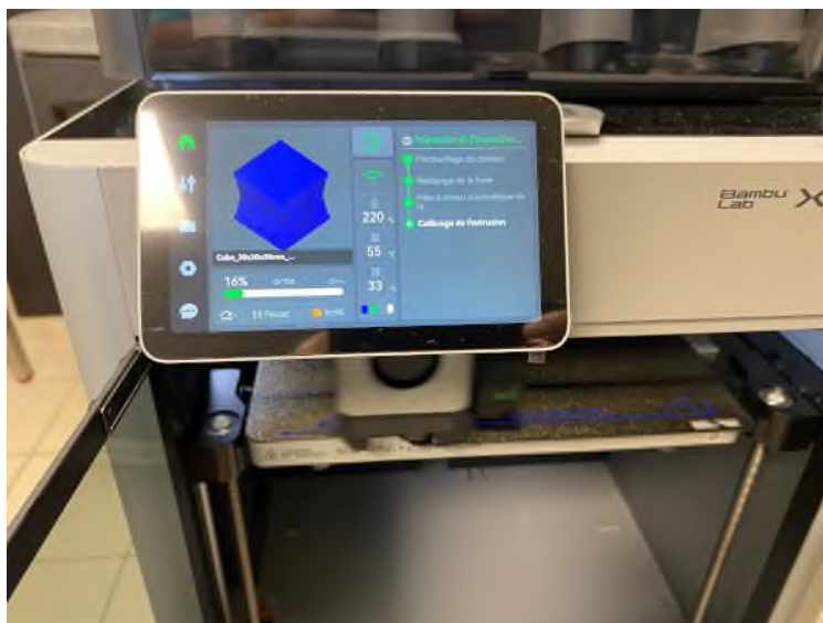
FIGURE 34 – Démarrage de l'impression : Calibrage de l'extrusion
