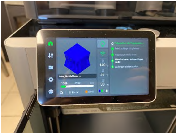
FIGURE 33 – Démarrage de l'impression : Mise à niveau automatique du lit
