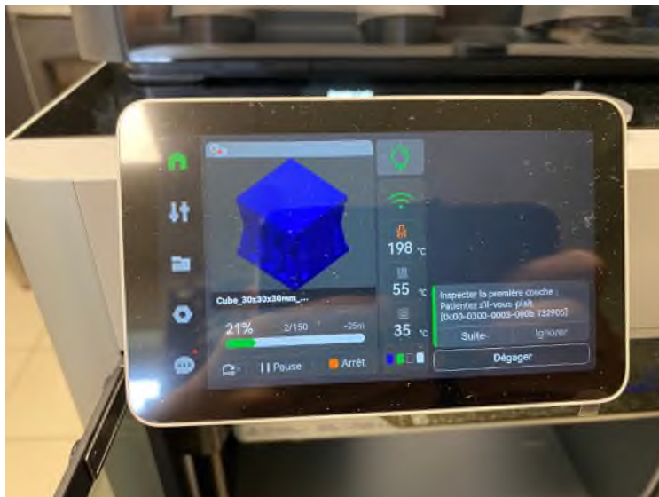
FIGURE 36 – Impression en cours : Inspection des premières couches
