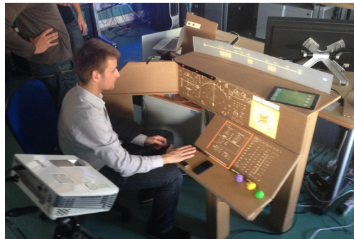
Figure 2. Création d'objet intermédiaire : maquette du cockpit en carton réalisé pour le CORAC en 2014
