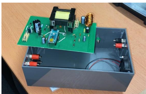
Figure 7 : Prototype de chargeur pour batterie au Sodium-ion
