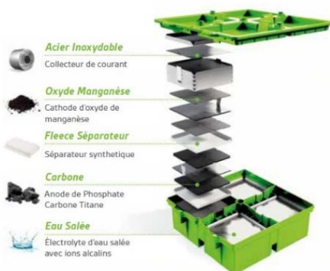
Figure 3 : Les différents éléments d'une cellule au sodium de la marque GreenRock (Stockage – Gerber Solar Sà)
