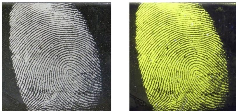
Fig. 2 : Développement d’une empreinte digitale, blanche avec un cyanoacrylate classique (à gauche) et directement fluorescente avec le Lumicyano TM à droite.
