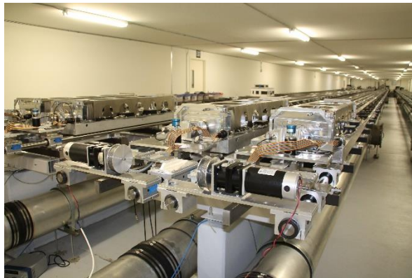
Figure 9 : Lignes à retard du réseau de télescopes CHARA
