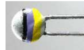
Thermistance : capteur de température
