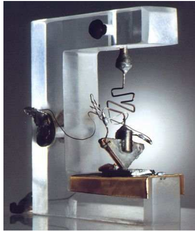
En 1947 : le premier transistor bipolaire (Shockley, Brattain, Bardeen)
