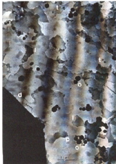
Fig. 2. Micrographie réalisée avec un MET d'un échantillon de carbone sur du cuivre. (© G. Ehret / CNRS/PCMS). La chercheuse a rajouté des lettres pour désigner les différents éléments présents sur l'image : O = oignon de carbone, D = filot de diamant, P = graphite polyédrique, T = tripode de carbone.
